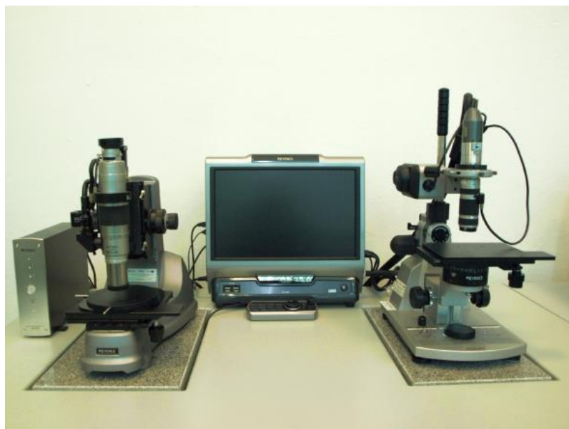
Rys. 23. Mikroskop cyfrowy firmy Keyence VHX-1000E wykorzystywany do obserwacji i pomiarów odcisków
