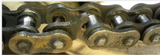
Rys. 10. Zerwana płytką wewnętrzną łańcucha
