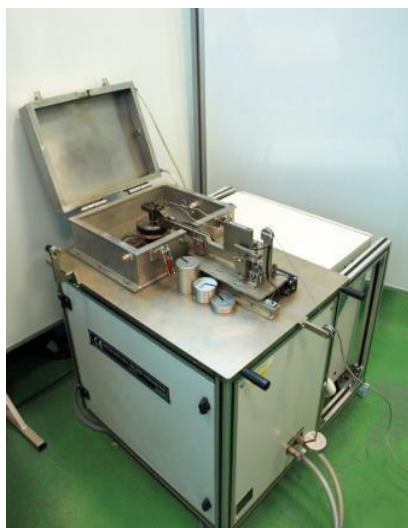
Rys. 28. Tester tribologiczny ball – on – disc firmy DUCOM
